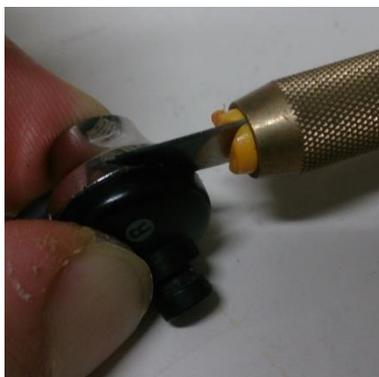
上の写真のようにデザインナイフでフロントハウジング(黒いプラスチックの部分)とリアハウジング(ステンレスの部分)の境目にデザインナイフを入れていきます。少しずつ刃を入れていき、ある程度差し込んだら刃を転がすようにして間隔を拡げていきます。
